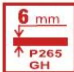
Kotao je izrađen od 6mm certificiranog kotlovskeg čelika (P265GH) iz T. Sendzimir Željezare - Arcelor Mittal Grupe;
