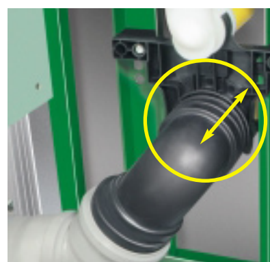
S u dubinu podesivim ispusnim lukom uštedjet ćemo dva standardna odvodna koljena, uz do 75 mm pomaka unutar zidnog nosača.
