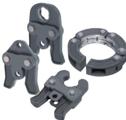
Kod alata za prešanje PT3-EH i PT3-AH rabe se za nazivne širine DN 10 - DN 50 čeljusti za prešanje, a za nazivne širine DN 65 - DN 100 lanci za prešanje.
