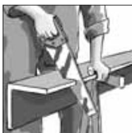
Element BA Balco Trepp skratite na željenu dimenziju pomoću pile.
