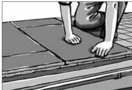
Ploče BA Balco položite na sloj ljepila te ih horizontalnim pomjeranjem u različitim smjerovima namjestite da leže punom površinom u ljepilu.
