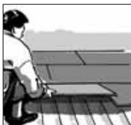
Ploču ugradite u ljepilo (po principu zidarskog veza).
