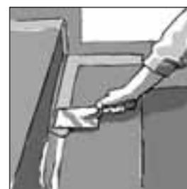
Nakon otvrdnjavanja ljepljiva ispod elemenata BA Balco Trepp, spojna mjesta zaptivaju se pomoću posebnog za to predviđenog kompleta za zaptivanje BA Balco (zaptivna traka i zaptivna masa).
