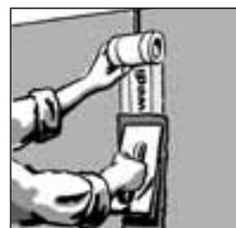
Zaptivanje spojeva: pregradni zid/postojeći zid s vanjske strane pomoću trake za armiranje, pregradni zid/postojeći zid s unutarnje strane pomoću trake za zaptivanje, pregradni zid/podni element s vanjske strane pomoću trake za armiranje, pregradni zid/podni element s unutarnje strane pomoću trake za zaptivanje.
